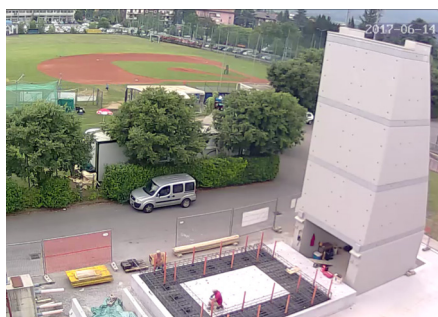
In alto: Strong wall per sollecitazioni orizzontali su edificio in scala reale. Predisposizione delle fondazioni per test sismico
